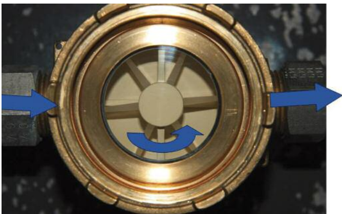
Bild 6: Draufsicht auf einen Einstrahl-Messkapselzähler mit modifizierter Staurippenplatte im Stillstand mit Angabe der Strömungsrichtung des Wassers beim Betrieb.
